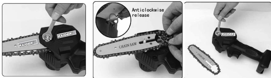
Înainte de montarea barei de ghidare şi a lanţului de tăiere, trebuie să verificaţi poziţia corectă a lamelor de tăiere pe lanţ (poziţia corectă a lanţului pe bară este indicată pe partea din faţă a barei). Purtaţi mănuşii de protecţie atunci când inspectaţi şi instalaţi lanţul pentru a evita rânilor cauzate de tăieturile ascuţite.
